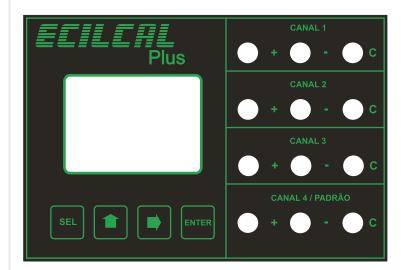
Portanto, um forno equipado com o **ECILCAL** constitui um sistema completo para a calibração de sensores de temperatura, pois reúne em um único instrumento portátil todos os elementos necessários para essa tarefa, tais como: fonte de calor, calibrador para medição de temperatura dos sensores, chave seletora e padrão interno.
